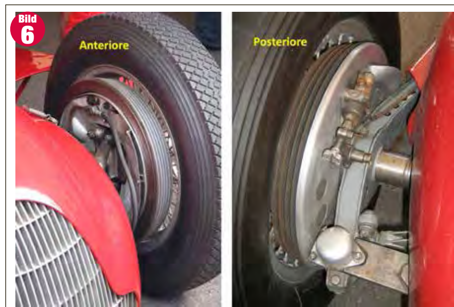
Till vänster, väl flänsad frambromstrumma med bromsslang och luftintag. Trummorna har dessutom stora lufthål, synliga inuti ekerfågarna, bild 2. Bakbromsen på bilden tillhör en 158 och har ett kopparrör som levererar bromsvätska till den på bromssköldens utsida monterade bromscylindern. En lätt åtkomlig ratt möjliggör snabb justering för slitage.
